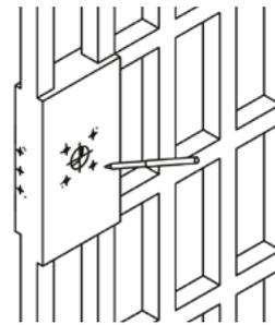
3. Marcar y perforar con una broca de 1/4" los agujeros para los pernos de la placa protectora.
