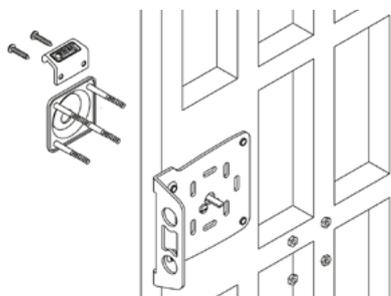
7. Fijar el protector exterior mediante sus 4 pernos y tuercas. Fijar también el jalador exterior con sus dos tornillos.
