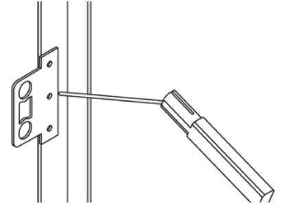
10. Colocar la caja de la cerradura por el lado interior de la puerta y fijarla con sus tornillos. **NOTA:** Para su correcto funcionamiento es importante que la lengüeta se coloque dentro del buje en la posición correcta (con el punto apuntando a la flecha de la tapa).
