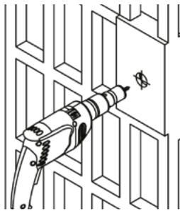
2. Utilizar la copa de sierra de 32 mm y realizar la perforación en ambos lados de la puerta.
