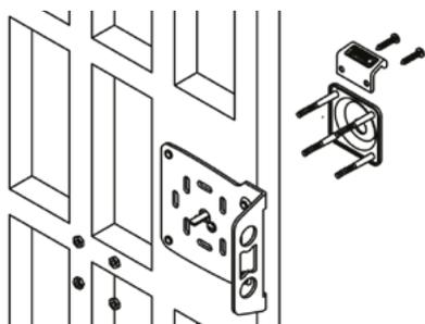
7. Fijar el protector exterior mediante sus 4 pernos y tuercas. Fijar también el jalador exterior con sus dos tornillos.
