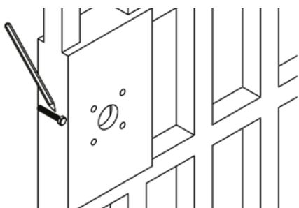
4. Cortar los stovebolts del portacilindro exterior a 0.5 cm menos del espesor de la puerta o reja. Por ejemplo, si es espesor de la puerta es de 4 cm, los stovebolts hay que cortarlos a 3.5 cm.
