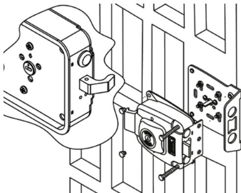
10. Colocar la caja de la cerradura por el lado interior de la puerta y fijarla con sus tornillos. **NOTA:** Para su correcto funcionamiento es importante que la lengüeta se coloque dentro del buje en la posición correcta (con el punto apuntando a la flecha de la tapa).
