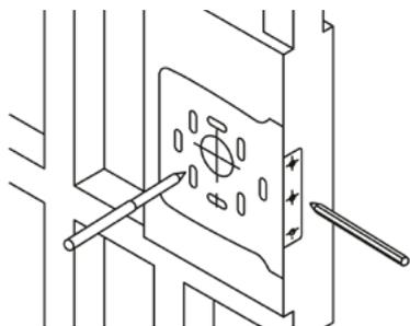
1. Marcar el punto de perforación desde la parte inferior de la puerta a 1 mt hacia arriba. Colocar la plantilla, marcar de 6.8 a 7 cm desde el borde de la puerta para el punto centro de perforación del portacilindro exterior.
