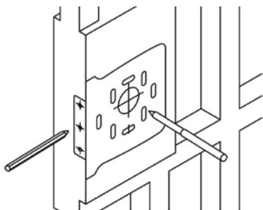
1. Marcar el punto de perforación desde la parte inferior de la puerta a 1 mt hacia arriba. Colocar la plantilla, marcar de 6.8 a 7 cm desde el borde de la puerta para el punto centro de perforación del portacilindro exterior.
