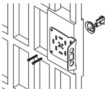
5. Colocar el portacilindro exterior y el aro como la imagen. Luego ajustar el planchón de la cerradura con los stovebolts.
