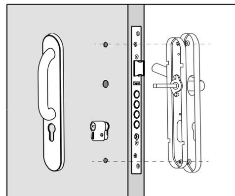
9. Instalar la manija y jalador. Sobreponer primero la roseta de la manija interior para marcar los puntos de perforación. Taladrar con una broca de 7 mm. Luego instalar por el lado exterior el jalador y atornillar.
