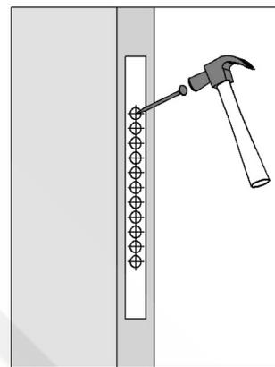
3. Marcar con la **PLANTILLA B** los centros para perforar la cavidad del mecanismo de la cerradura.
