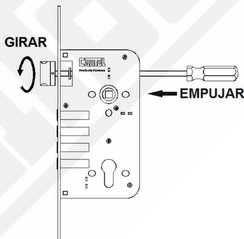
2. Presionar el picaporte hasta que esté fuera del frontis y girar. Retirar el destornillador suavemente y comprobar que el picaporte esté en la posición deseada.
