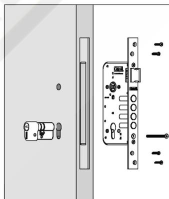
8. Instalar el mecanismo de la cerradura y el portacilindro en la puerta como se muestra en la imagen.
