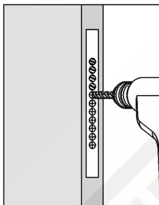
4. Taladrar la cavidad para el mecanismo de la cerradura (con una broca de 16 mm y una profundidad por agujero de 10 cm).
